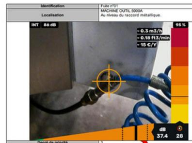
Illustration du repérage d'une fuite sur le réseau d'air comprimé
